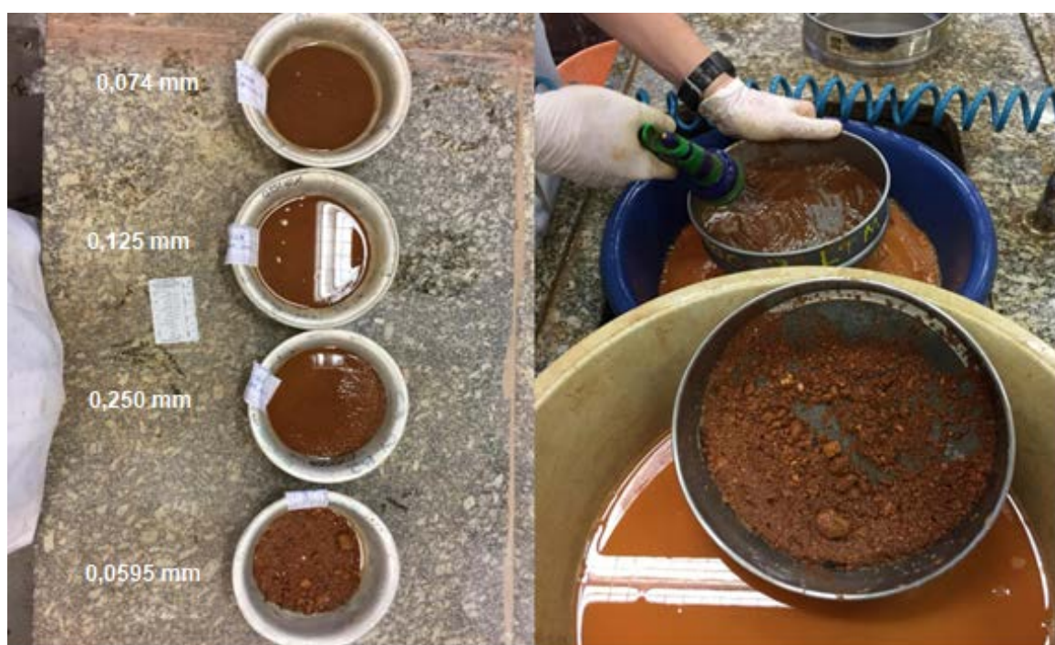
Figura 6: Etapa de classificação da amostra por peneiramento em meio úmido (Lucas Stahl, 2020, acervo pessoal).
