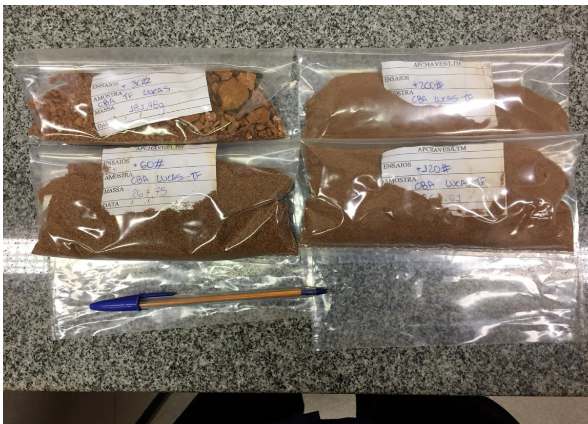
Figura 9: Amostras retidas em cada peneira, destaca-se que a granulometria abaixo de 0,074mm foi direcionada para o cyclosizer (Lucas Stahl, 2020, acervo pessoal).
