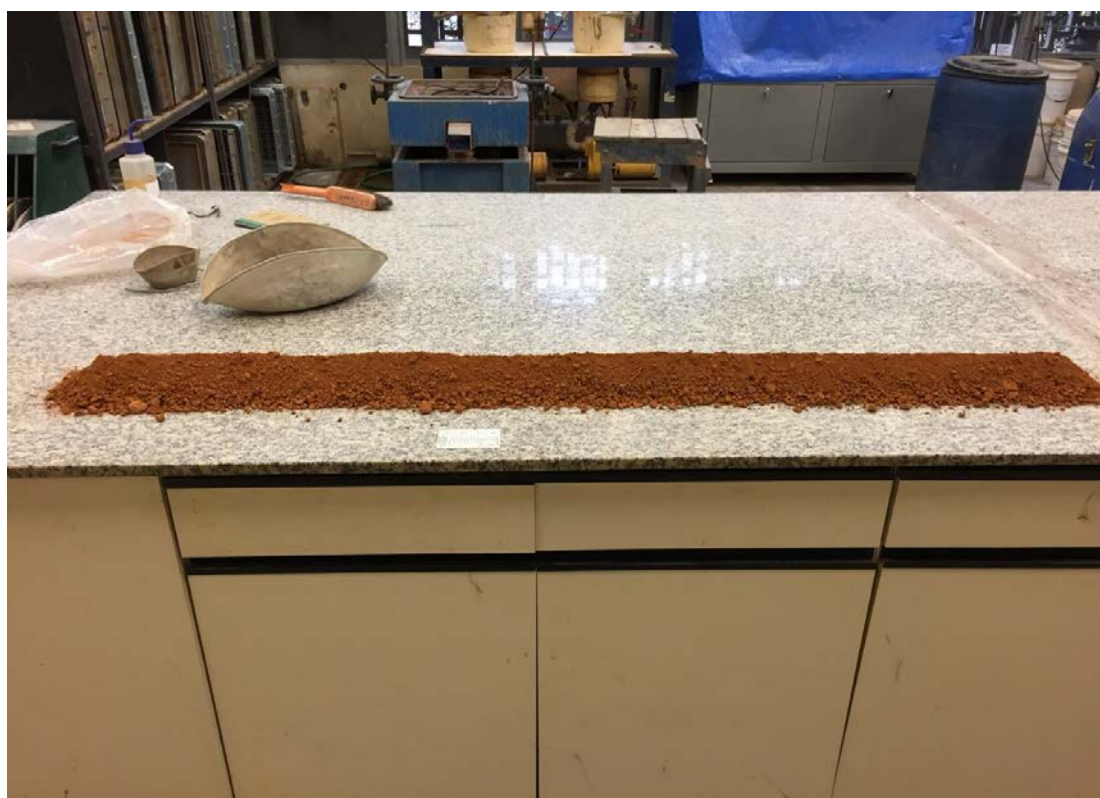
Figura 5: Homogeneização do material pelo método de pilha alongada, para realização do quarteamento da amostra (Lucas Stahl, 2020, acervo pessoal).
