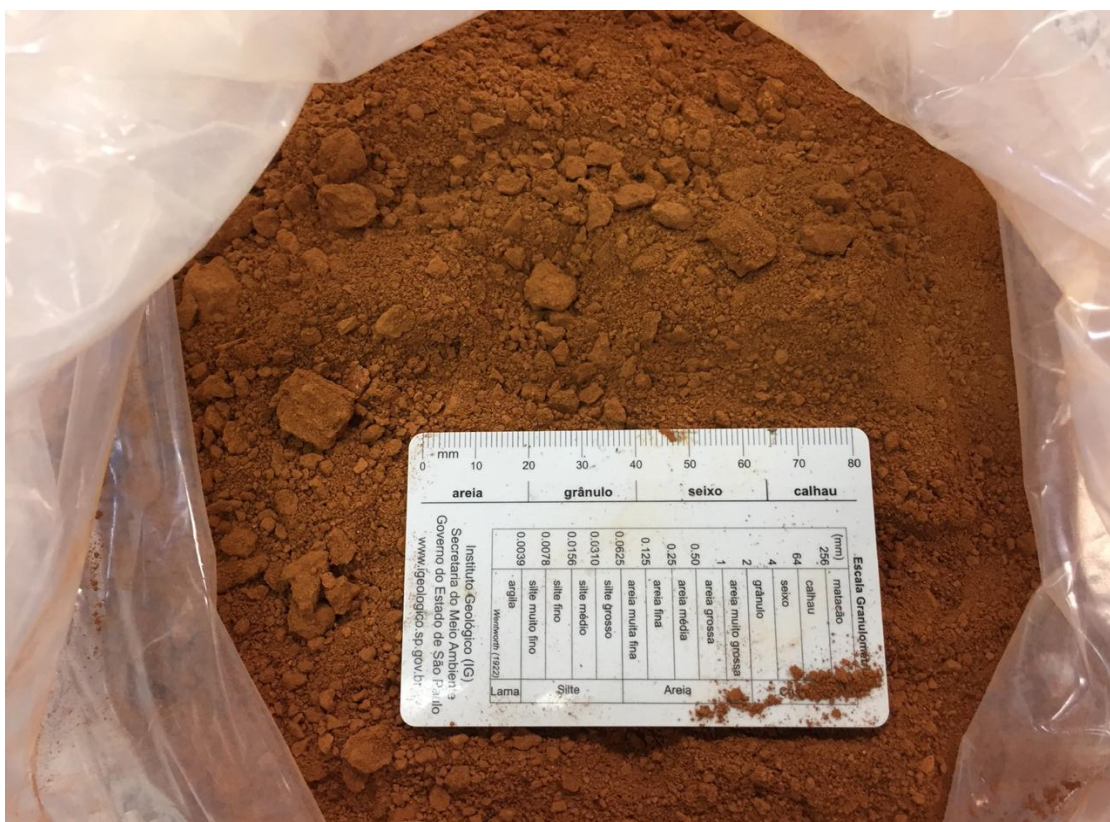
Figura 4: Amostra composta pelos rejeitos finos do beneficiamento da bauxita (Lucas Stahl, 2020, acervo pessoal).
